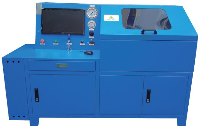
根据客户要求满足被测试样的最大为5MPa的水锤试验及10MPa的静压爆破专用试验机。用于净水器整机、纯水机、滤瓶、压力桶等产品的耐水锤冲击测试，帮助净水器企业检测产品能否满足标准要求以及新产品的研发提供数据支持，设备微机控制，压力曲线可视，实验数据自动存储并可生成打印报表。
